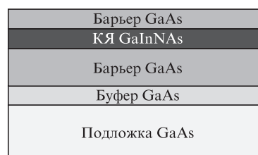
Рис.1. Схема поперечного сечения образца КЯ GaInNAs.
