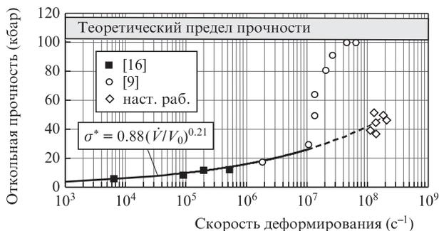
Рис.5. Зависимости откольной прочности  $\sigma^*$  мишеней из алюминий-магниевого сплава АМг6М от скорости деформирования  $\dot{V}/V_0$  (экспериментальные данные).
