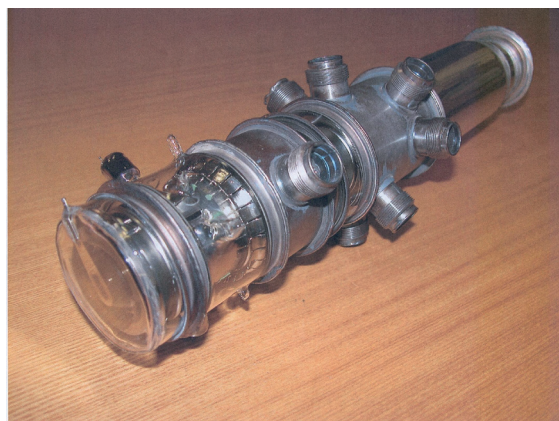
Рис.2. Модернизированный образец гибридного устройства «ЭОП – фотоэлектронная пушка».
