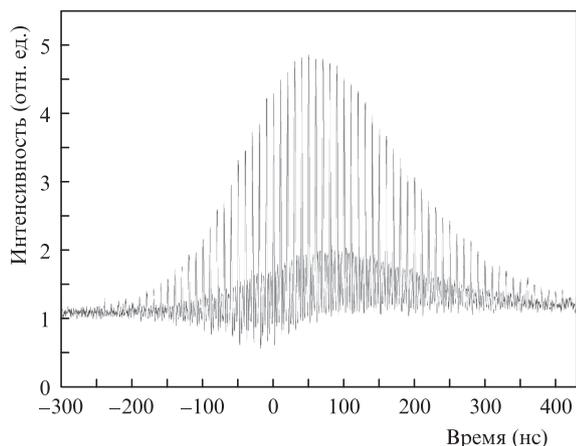
Рис.2. Осциллограмма излучения цуга лазерных импульсов.
