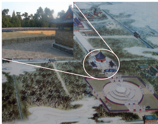
Рис.4. Акустический резонатор МШГ – стена эха в Храме Неба, Пекин: изображение на плане и фотография (вставка).
