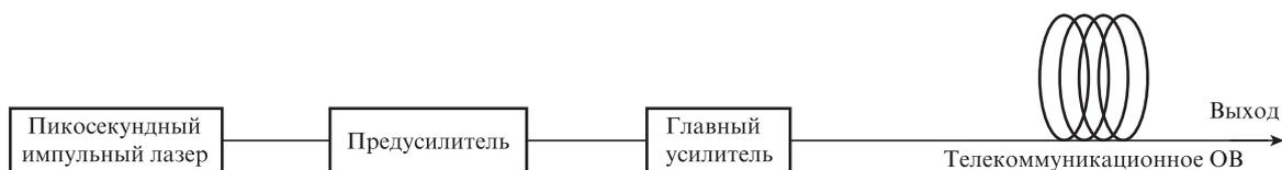
Рис.1. Волоконная система генерации СК.
