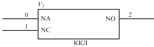
Рис.3. Символическое изображение обычных терагерцевых ККЛ: NA – анод; NC – катод; NO – оптический выход.
