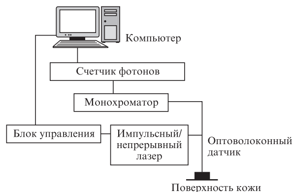
Рис.4. Схема установки для параллельного детектирования времени жизни возбужденного состояния и параметров фотообесцвечивания АФ кожи.
