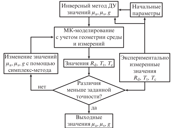
Рис.2. Блок-схема использованного метода определения оптических параметров биоткани.
