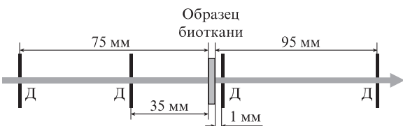
Рис.1. Схема приставки для измерения коллимированного пропускания образцов биоткани; Д – диафрагма \varnothing 2 мм.
