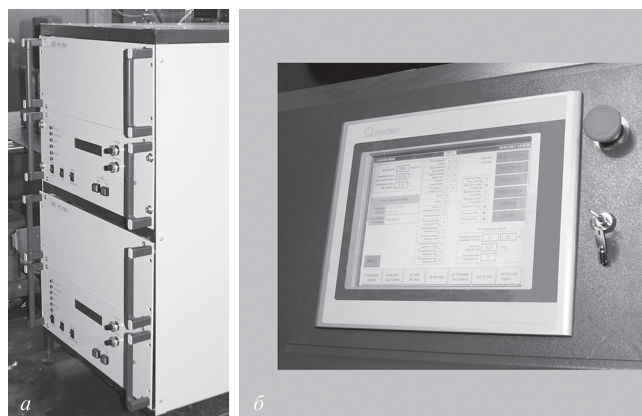
Рис.2. Источники питания (а) и сенсорный пульт управления (б).
