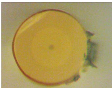
Рис.2. Изображение торца волоконного световода диаметром 140 мкм в полиимидном покрытии толщиной 3 мкм.
