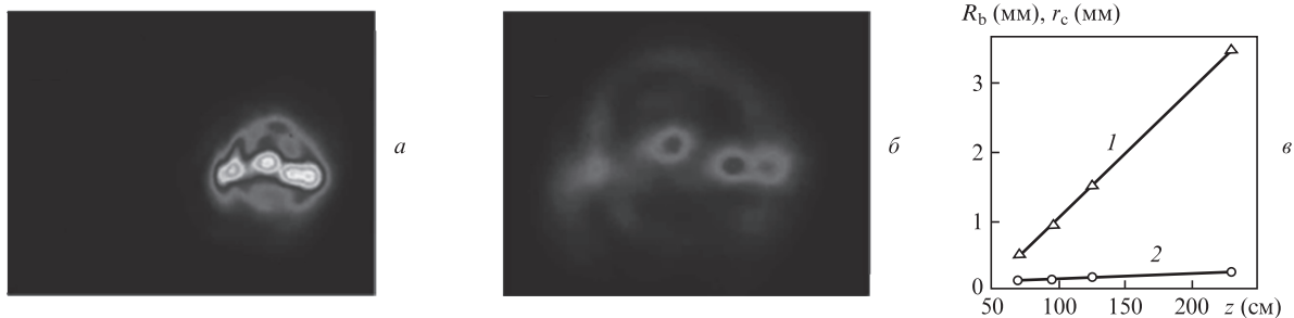
Рис.2. Распределения поперечного профиля плотности энергии излучения с E_0 = 3.9 мДж на расстояниях от линейного фокуса пучка z = 125 (а) и 230 см (б) при f = 52 см; в – зависимости эффективного радиуса всего пучка R_b (1) и ПФК r_c (2) от расстояния от линейного фокуса z .
