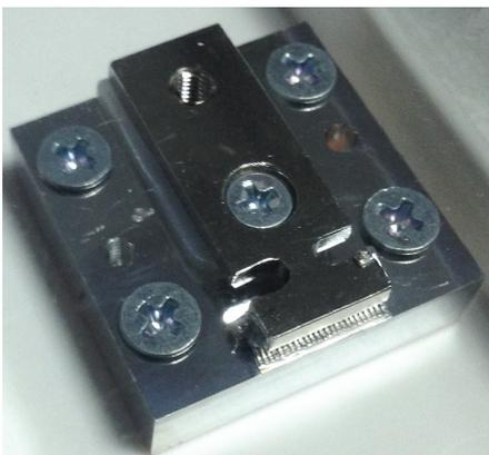
Рис.3. Фотография собранной в корпусе типа С–S-маунт квазинепрерывной ЛДЛ5 мощностью 300 Вт, излучающей в спектральной области 808 нм.
