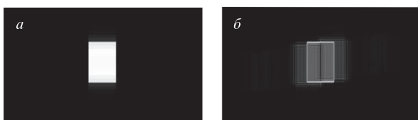
Рис.3. Исходное изображение (а) и его вид после фурье-обработки (б) с использованием выделенного участка на рис.2 в качестве фильтра пространственных частот.
