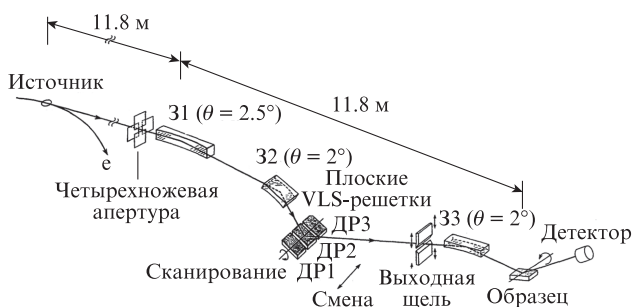
Рис. 10. Схема рефлектометра на основе монохроматора со сменными плоскими VLS-решетками (ДР1–ДР3), использующего синхротронное излучение: 31, 32 – сферические зеркала скользящего падения; 33 – цилиндрическое зеркало скользящего падения; \Omega = 8^\circ . (Адаптировано из [28].)
