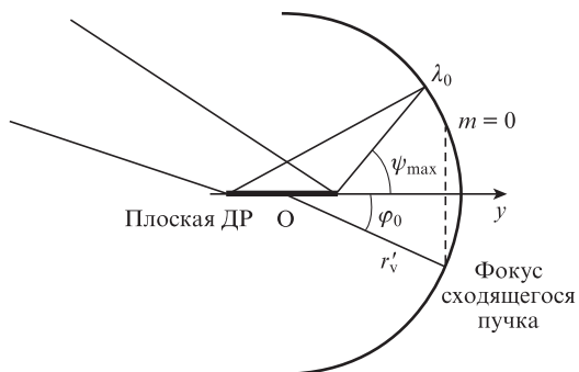
Рис.12. Выполнение условия стигматизма на длине волны \lambda_0 за счет изменения шага штрихов на апертуре плоской VLS-решетки, установленной в сходящемся гомоцентрическом пучке, согласно уравнению (20). Как и в случае классической ДР, вертикальный фокус дифрагированных пучков лежит на окружности радиуса r'_v , описанной вокруг центра решетки O ; порядок дифракции внутренний; расстояние между штрихами решетки уменьшается в направлении оси y .
