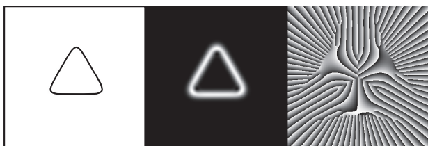
Рис.1. Порождающая кривая и соответствующие ей распределения интенсивности и фазы спирального пучка.
