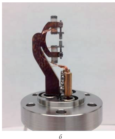
Рис.3. Конфигурация электродов и схема подачи напряжения в торцевой ионной ловушке (а) и электроды ловушки в сборе на вакуумном фланце диаметром 50 мм (б).
