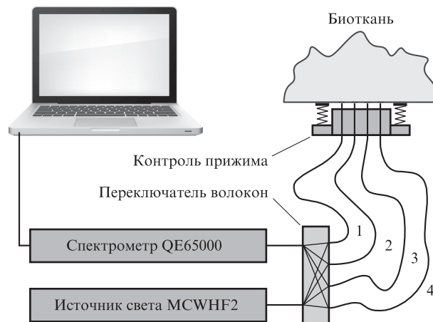
Рис.3. Схема ОДС-системы для оценки кислородного насыщения биологических тканей с использованием отражательной геометрии спектроскопических измерений.
