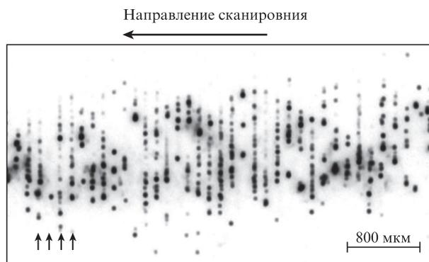
Рис.2. Негативная микрофотография лазерно-индуцируемой плазмы, полученная при облучении раствора  $^{152}\text{Eu}$  с наночастицами никеля дугом лазерных импульсов. Вертикальные стрелки указывают на плазменные треки, созданные отдельными лазерными импульсами в перетяжке лазерного пучка. Использовался Nd:YAG-лазер с длительностью импульсов 10 нс, частотой их следования 10 кГц и энергией импульса 1.6 мДж. Скорость сканирования лазерного пучка 1.25 м/с.
