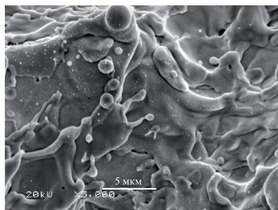
Рис.3. СЭМ-изображения поверхности золотой мишени после лазерной абляции, полученные при регистрации под углами 0 (а) и 20° (б, в). На вставке на рис.3,а приведен результат ЭДА (рентгеновский спектр) двух выделенных участков поверхности мишени, один из которых содержит микросферу. Элементный состав микросферы идентичен составу всей поверхности (а).
