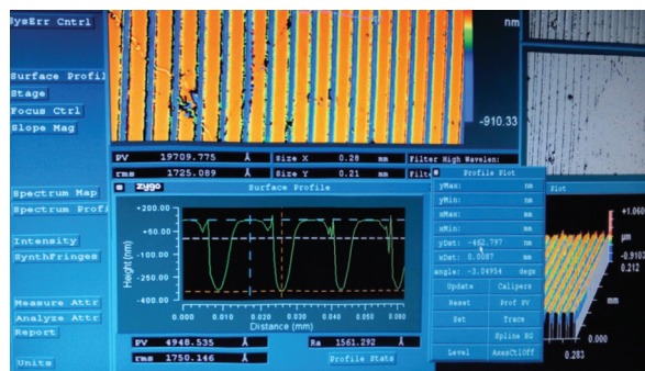
Рис.4. Результаты измерения характеристик линзы Френеля на атомно-силовом микроскопе (а) и на интерферометре белого света (б).
