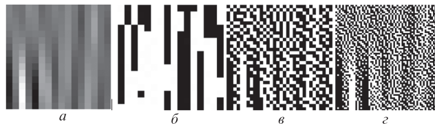
Рис.3. Фрагмент исходной голограммы (а), он же, бинаризованный методом Отсу (б) и представленный случайными растрами с пятью (в) и 17 (г) градациями.
