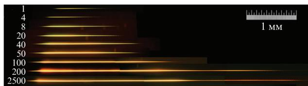
Рис. 1. Фотографии люминесцирующих волноводов из долгоживущих ЦО, записанных в LiF под действием различного числа фемтосекундных импульсов лазерного излучения с  $\lambda = 3200$  нм. Вклад в видимую люминесценцию вносят ЦО, возбуждаемые непрерывным лазером с длиной волны излучения 450 нм. Фемтосекундные импульсы идут слева направо, цифры слева – число импульсов.
